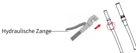
Abbildung 5.4 Crimpen Sie den Kontaktstift an den Draht
