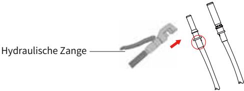
Abb. 3.4 Klemmen Sie den Kontaktstift an den Draht
