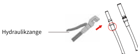
Bild 6.4 Crimpen des Kontaktstifts an den Draht
