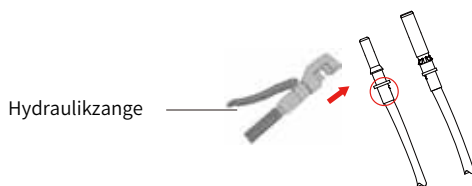
Bild 3.4 Crimpen des Kontaktstifts an den Draht
