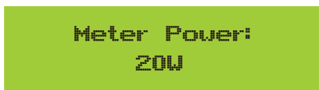
Abb. 7.36 Null-Export-Funktion über Energiezähler einschalten
