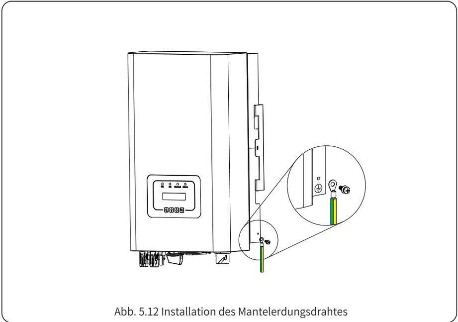
Abb. 5.12 Installation des Mantelerdungsdrahtes
