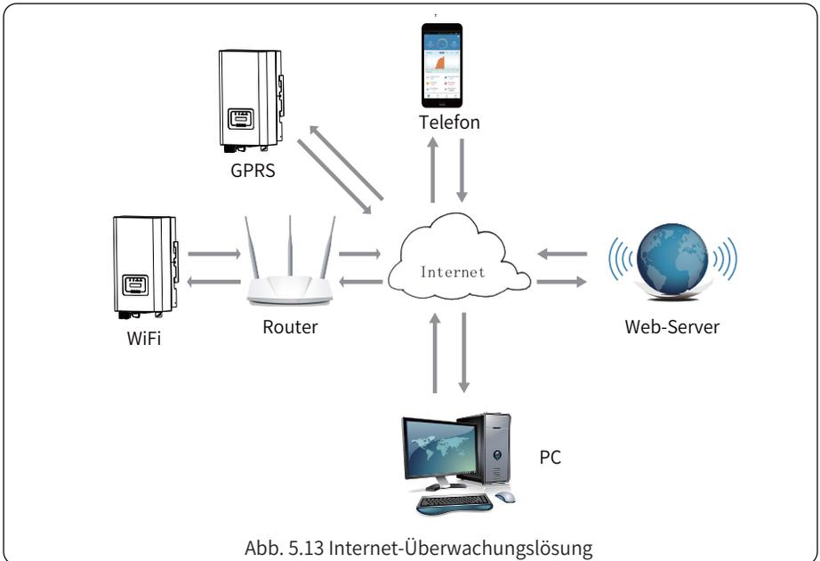
Abb. 5.13 Internet-Überwachungslösung
