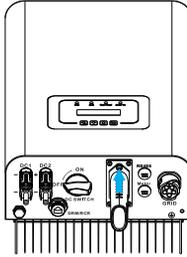
Abb. 5.14 Installationsschema des Datenloggers
