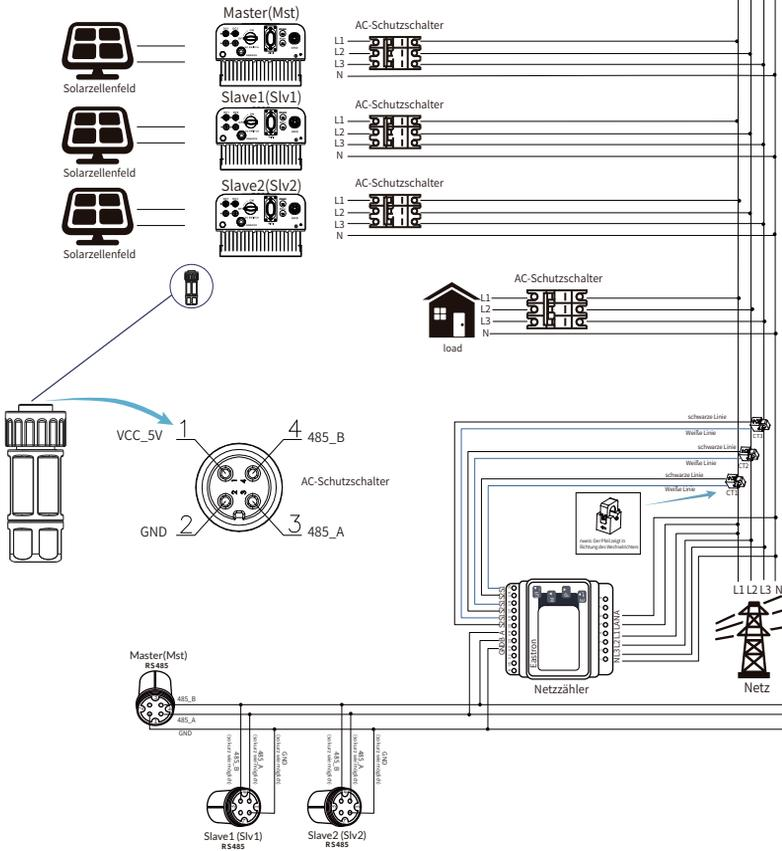
Abb. 7.23 Anschlussplan (Dreiphasenstrom)
