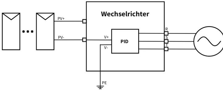
Das Anti-PID-Modul behebt den PID-Effekt des PV-Moduls in der Nacht, das PID-Modul läuft immer, wenn es an AC angeschlossen ist.
