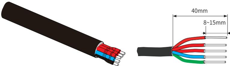
Abb. 5.8 AC-Kabel abisolieren
