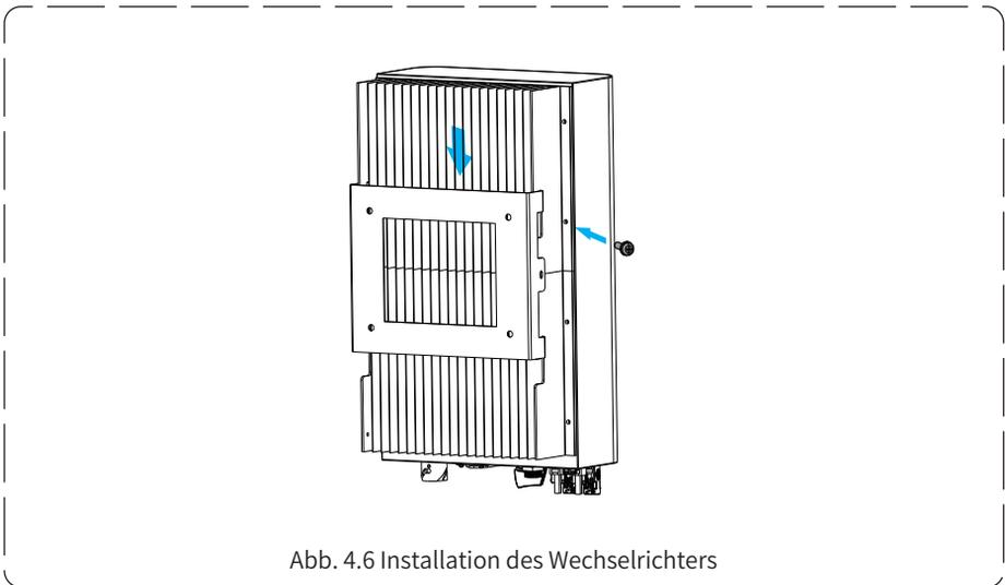
Abb. 4.6 Installation des Wechselrichters
