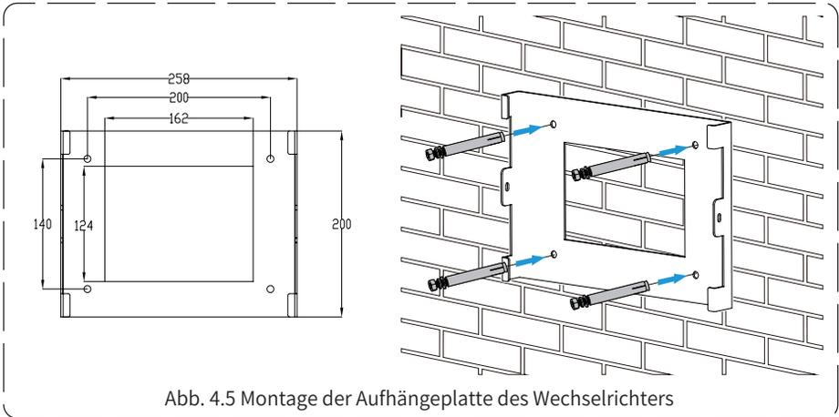
Abb. 4.5 Montage der Aufhängeplatte des Wechselrichters
