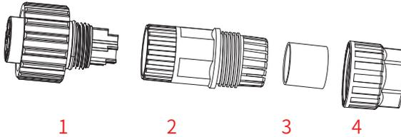
1. Passende Muffe 2. Hülse 3. Dichtungskern 4. Dichtungsmutter
