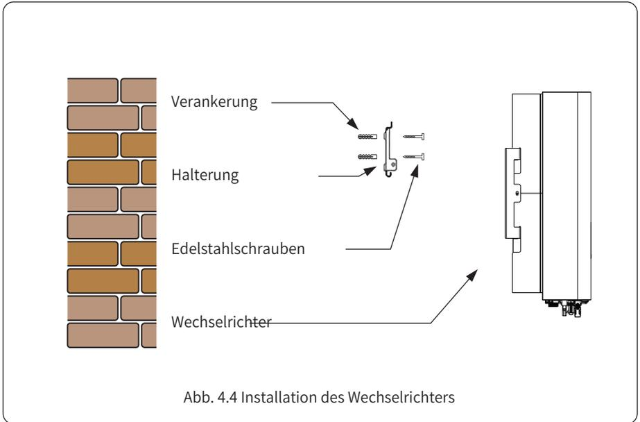
Abb. 4.4 Installation des Wechselrichters
