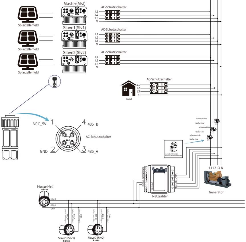
Abb. 7.25 Anschlussplan (Dreiphasenstrom)
