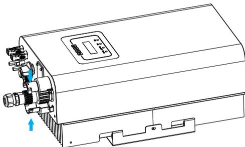
Abb. 5.11 Fügen Sie eine dreiphasige Schutzhülle für
